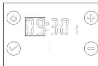
6.5.1.4 Krátce stiskněte tlačítko dokud nezačne blikat minutová hodnota, nastavení se provádí pomocí tlačítek +/-, pokud přístroj nezaznamená aktivitu po dobu 30 sekund, automaticky se přepne do režimu nastavení týdne.
