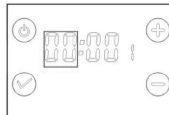
6.5.1.2 Chcete-li změnit hodnotu, stiskněte tlačítko +/- pro snížení nebo zvýšení hodnoty, pokud zařízení nezaznamená aktivitu po dobu 30 sekund, automaticky se přepne do režimu nastavení minut.
