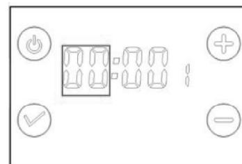
6.5.1.2 Ak chcete zmeniť hodnotu, stlačením tlačidla +/- znižte alebo zvýšte hodnotu, ak zariadenie nezaznamená aktivity počas 30 sekúnd, automaticky sa prepne do režimu nastavenia minút.
